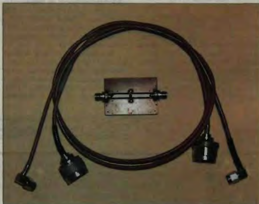
7. ábra. A kész mérőpanel fényképe az SMA-N mérőkábelekkel
