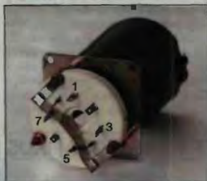
12. ábra. A GU-50 lábkiosztása: 1 - katód, 2 - vezérlőrács, 3 - segédrács, 4 és 8 - fűtés, 5 - fékezőrács, 6 - anód, 7 - árnyékolás
