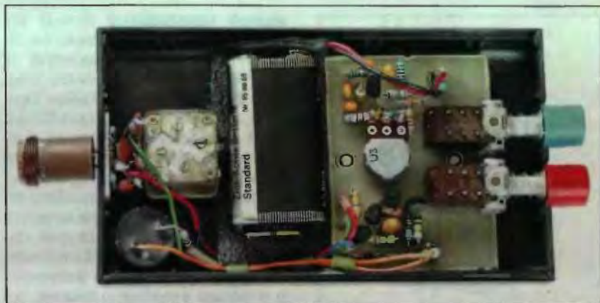
3. ábra. A GDO belső felépítése (alulnézet)
